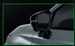
ระบบแสดงภาพมุมอับสายตา ขณะเปลี่ยนเลน (Honda LaneWatch)
