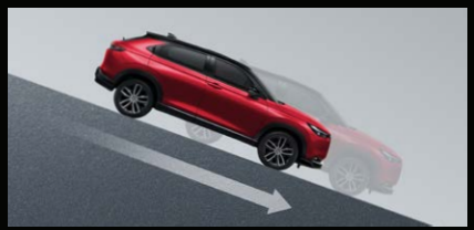
Hill Descent Control (HDC) ระบบควบคุมความเร็วขณะลงทางลาดชัน
